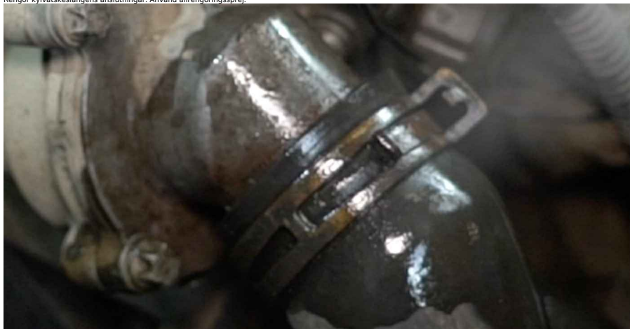
16 Lossa kylvätskeslangarnas klämmor. Använd Clic-R-klammertänger.
