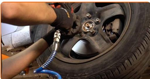
**40** Sänk bilen och arbeta i omvänd ordning, dra åt hjulbultarna. Använd en momentnyckel. Dra åt den till 110 Nm vridmoment.
