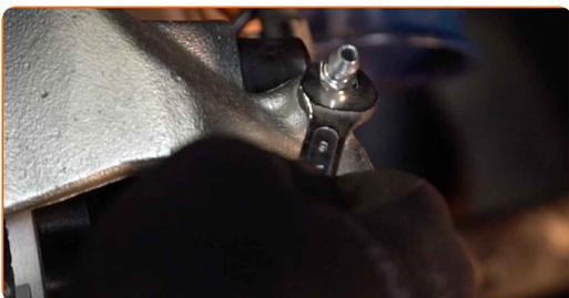
**30** Koppla bromsluftaren till bromsluftarskruven.
