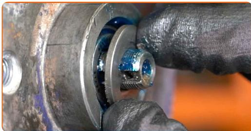
**26** Skruva på centrummuttern. Använd hylsnyckel Nr24. Använd en spärrnyckel.
