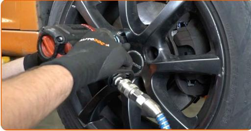
34 Sänk bilen och arbeta i omvänd ordning, dra åt hjulbultarna. Använd hjulmutterhylsor nr. 17 Använd en momentnyckel. Dra åt den till 100 Nm vridmoment.
