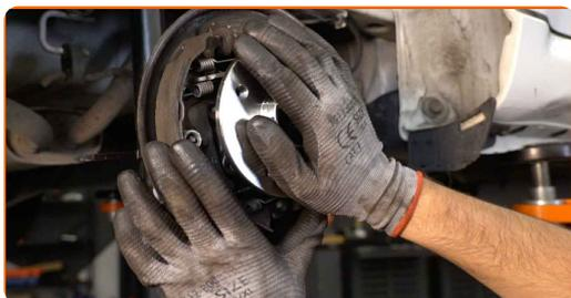
**17** Dra åt hjulnavlagrets fästbulten. Använd hylsnyckel Nr12. Använd en momentnyckel. Dra åt den till 60 Nm vridmoment.
