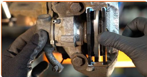
**25** Montera bromsklossarnas hållare. Använd en kofot.
