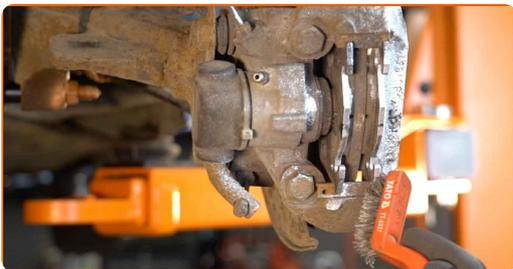
**10** Ta bort hållarna för bromsklossarna. Använd en kofot. Använd en gummihammare.
