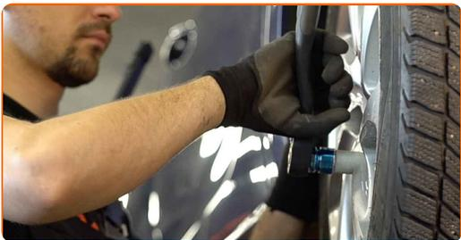
**34** Sänk bilen och arbeta i omvänd ordning, dra åt hjulbultarna. Använd en momentnyckel. Dra åt den till 100 Nm vridmoment.
