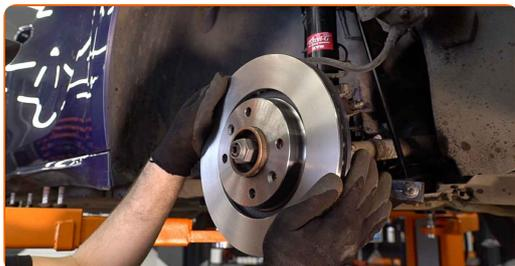
**22** Dra åt bromsskivans fästelement. Använd Torx T30. Använd en momentnyckel. Dra åt den till 9 Nm vridmoment.
