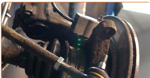
**11** Skruva loss änden från parallellstaget.
