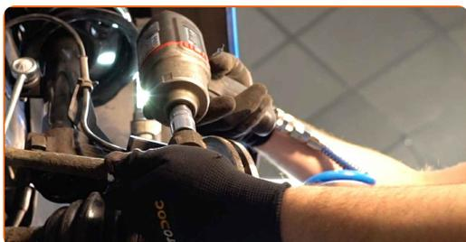
**10** Koppla bort parallellstagsänden från styrspindel. Använd ett körnare dorn. Använd en hammare.
