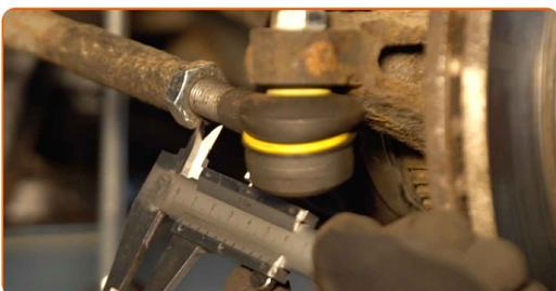
**7** Lossa på låsmuttern som håller fast parallellstagsänden med parallellstaget. Använd kombinyckel Nr 22.
