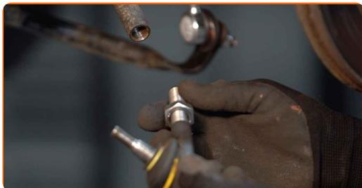
**12** Rengör monteringsställen av styrstagetsände. Använd en stålborste. Använd WD-40 aerosol.
