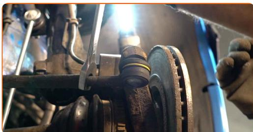
**9** Skruva loss fästmuttern från styrspindelns ände. Använd hylsnyckel Nr17. Använd en trycknyckel.
