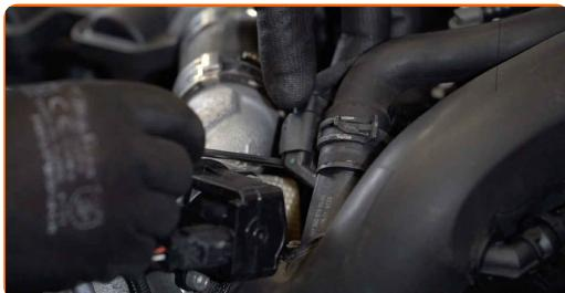
**3.2** Pressa klämmnan med en kombinationstång och koppla bort vakuumventil slangen.
