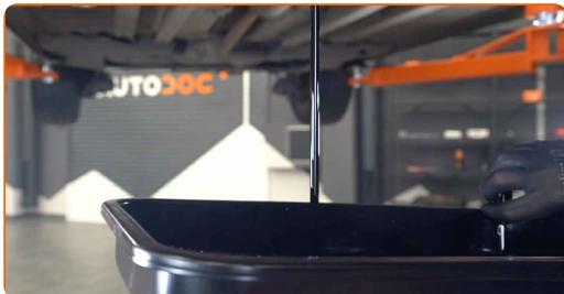
Utbyte: motorolja och filter – PEUGEOT 3008 I (OU\_). Tips:
