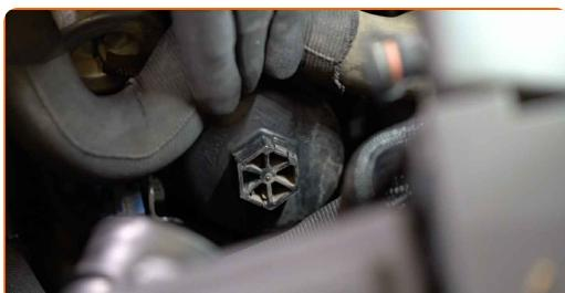
**11** Skruva loss filterhusets lock och dess gamla filterelement. Använd hylsnyckel Nr27.
