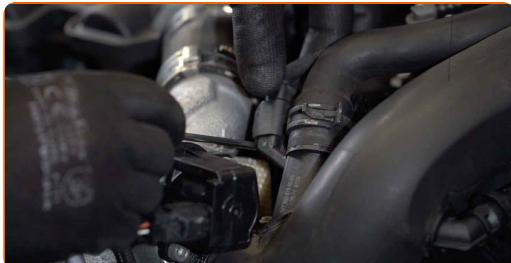
**3.2** Pressa klämmen med en kombinationstång och koppla bort vakuumventil slangen.
