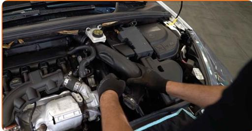
**8** Skruva av klammer och fästelement på luftfiltrets insugsrör. Använd kombinyckel Nr 7. Använd hylsnyckel Nr10.
