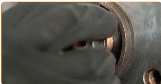
87 Dra åt bulten på drivaxeln. Använd hylsnyckel Nr35. Använd en momentnyckel. Dra åt den till 245 Nm vridmoment.
