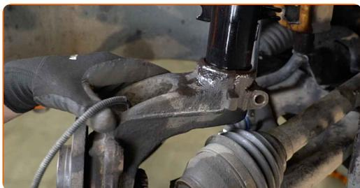
56 Justera fjäderbenet på styrspindeln.
