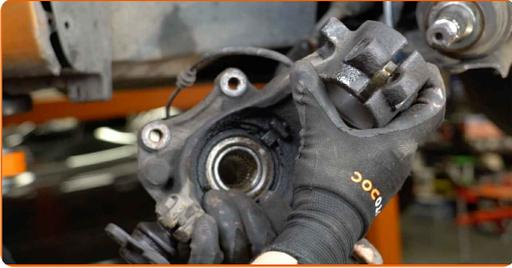
36 Placera styrspindeln ihopmonterad med hjulnavet i ett skruvstäd.
