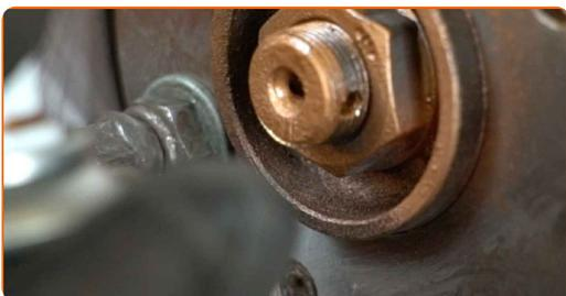
89 Installera axelmutterns sprint på drivknuten. Använd en kofot.
