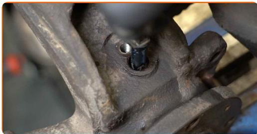
53 Dra åt fästet som kopplar ihop ABS-sensorn med styrspindeln. Använd hylsnyckel Nr13. Använd en momentnyckel. Dra åt den till 10 Nm vridmoment.
