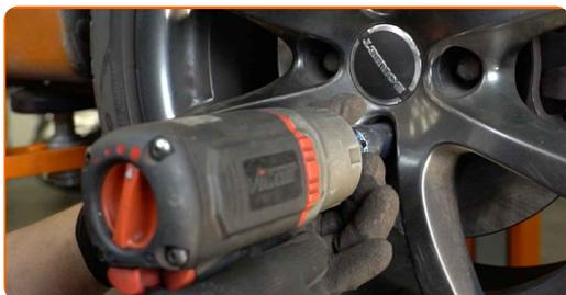
96 Sänk bilen och arbeta i omvänd ordning, dra åt hjulbultarna. Använd hjulmutterhylsor nr. 17 Använd en momentnyckel. Dra åt den till 100 Nm vridmoment.
