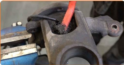
38 Skruva loss ABS-sensorns fästelement. Använd hylsnyckel Nr13. Använd en spärrnyckel.
