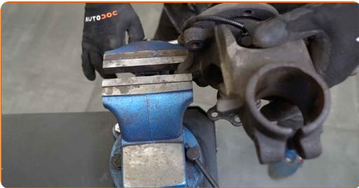
37 Rengör ABS-sensorns monteringsfäste. Använd en stålborste. Använd WD-40 aerosol.
