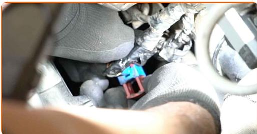
**4** Rengör lambdasondens fäste. Använd en stålborste. Använd WD-40 aerosol.
