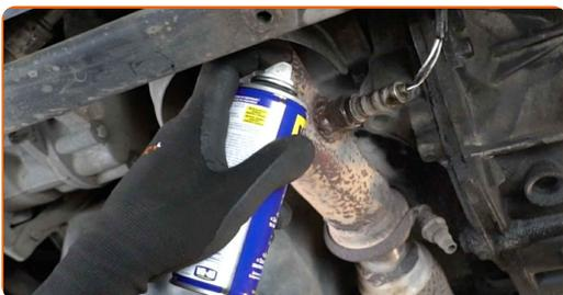
**5** Skruva loss lambdasondens fäste. Använd en 22 mm hylsa för lambdasond. Använd en spärrnyckel.
