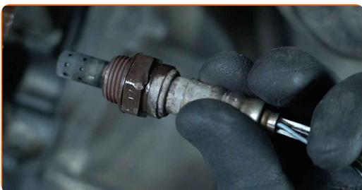
**7** Rengör lambdasondens monteringsfäste. Använd WD-40 aerosol.
