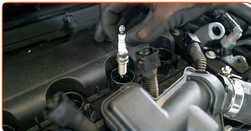
**10** Skruva fast och dra åt de nya tändstiften. Använd 12-kants tändstiftshylsan #14. Använd en momentnyckel. Dra åt den till 23 Nm vridmoment.
