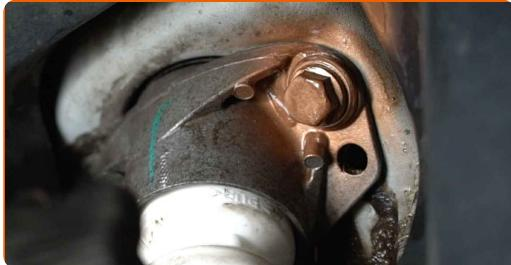
**29** Skruva åt fästena. Använd Torx T27.
