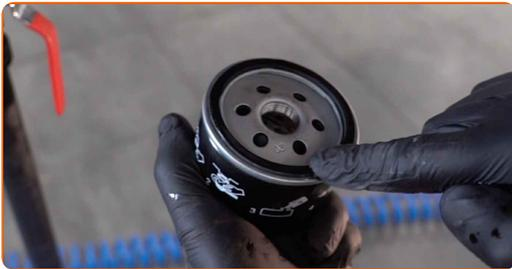
14 Skruva fast det nya filtret på sin plats. Använd hylsnyckel 76/14-F. Använd en momentnyckel. Dra åt den till 21 Nm vridmoment.
