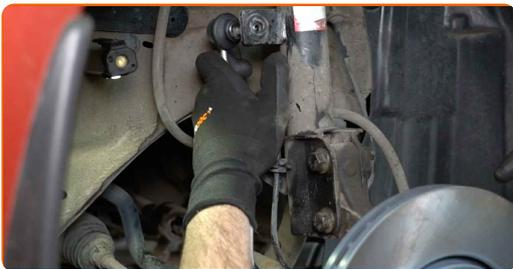
**12** Dra åt fästningarna som kopplar stabiliseringslänken till stötdämparen. Använd hylsnyckel Nr17. Använd en momentnyckel. Dra åt den till 44 Nm vridmoment.
