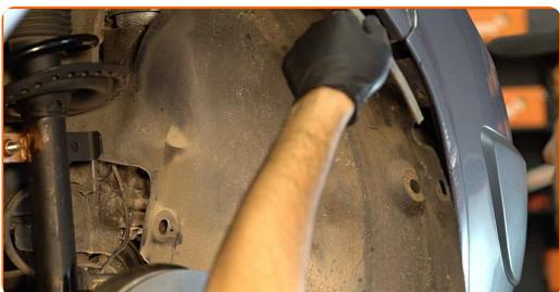
**20** Montera och dra åt fästningarna till hjulbågsskyddet. Använd Torx T25. Använd en spärrnyckel.
