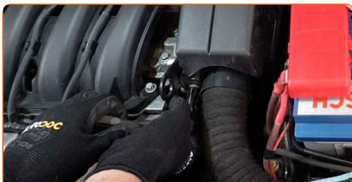
4 Koppla bort luftinsugsröret från luftfilterboxen.
