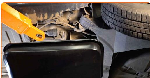
**4** Tryck ihop klämmorna och lossa matarledningarna från oljefilterhuset. Använd bränslerörstänger.
