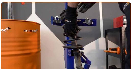
Utbyte: fjäderbenslagring – RENAULT Megane II Hatchback (BM, CM). Tips
