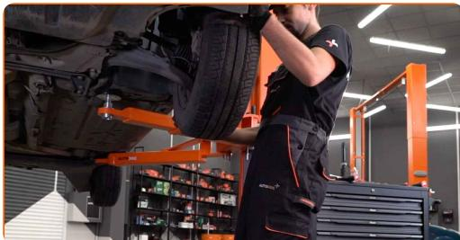
Utbyte: fjäderbenslagring – RENAULT Megane II Hatchback (BM, CM).
