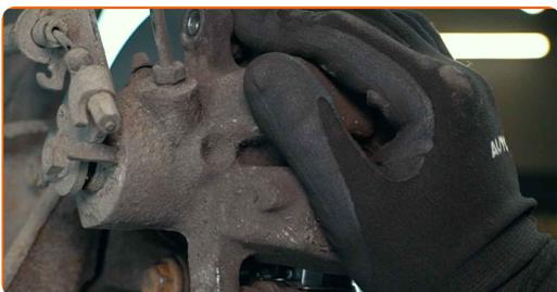
**17** Dra åt fästelementen till bromsoket. Använd kombinyckel Nr 13. Använd hylsnyckel Nr13. Använd en momentnyckel. Dra åt den till 30 Nm vridmoment.
