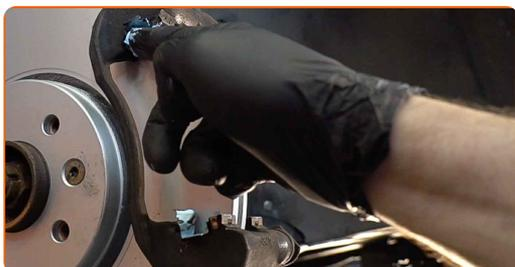
Utbyte: bromsbelägg – RENAULT TWINGO II (CN0\_). Tips från AUTODOC:
