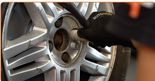
**22** Sänk bilen och arbeta i omvänd ordning, dra åt hjulbultarna. Använd en momentnyckel. Dra åt den till 110 Nm vridmoment.
