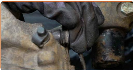
**21** Installera bromsokets spärrfjäder. Använd en kofot.
