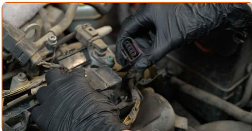
**8** Behandla tändspolekontakt med elektronikspray. Sprayen kommer att skydda emot rostning, och kommer att reducera friktionen på kontaktytorna.
