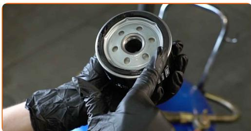
**15** Skruva fast det nya filtret på sin plats. Använd hylsnyckel Nr30. Använd en momentnyckel. Dra åt den till 26 Nm vridmoment.
