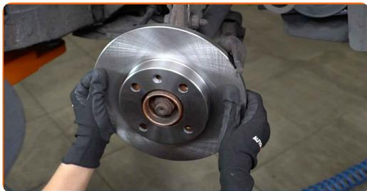
**19** Dra åt bromsskivans fästelement. Använd Torx T30. Använd en momentnyckel. Dra åt den till 4 Nm vridmoment.
