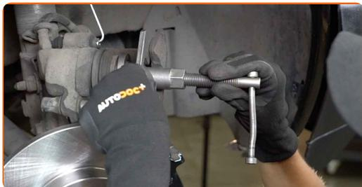
**23** Installera bromsoket och justera den. Använd HEX Nr. H6. Använd en momentnyckel. Dra åt den till 25 Nm vridmoment.
