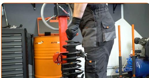
**32** Montera det övre fjäderbensfästet och fjäderbenslagret.
