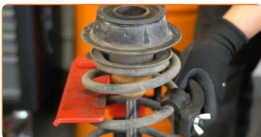
**22** Avlägsna fjäderbenets ställmutter. Använd kombinyckel Nr 21. Använd en 14,5 mm mutterhylsa för fjäderben. Använd en spärrnyckel.
