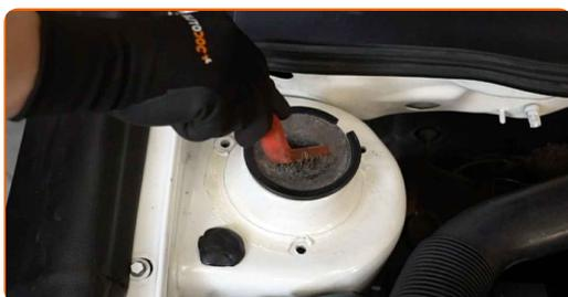
**4** Lossa på de övre fästena på stötdämparen fästningar. Använd HEX Nr. H6. Använd hylsnyckel Nr21. Använd en spärrnyckel.
