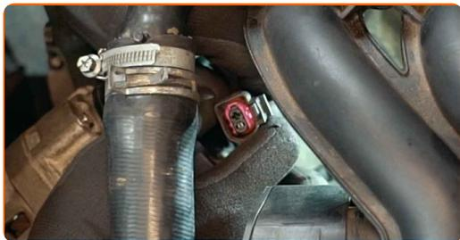
**26** Skruva loss fästet till generatorns elkabel. Använd kombinyckel Nr 13.
