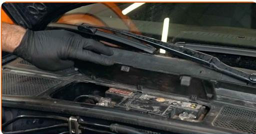
19 Skruva loss fästen till bilbatteriklämmorna. Använd kombinyckel Nr 10.
