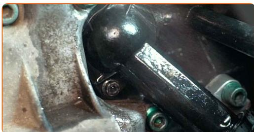
**28** Skruva loss fästena till termostatens hölje. Använd hylsnyckel Nr10. Använd en spärrnyckel.
