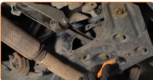
**7** Skruva loss fästningarna som kopplar motorfästet till växellådshuset. Använd hylsnyckel Nr16. Använd en spärrnyckel.
