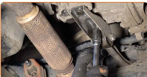
**8** Skruva loss motorns fästningar som kopplas ihop med underramen. Använd hylsnyckel Nr16. Använd en spärrnyckel.
