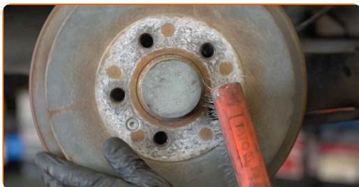
**37** Behandla ytan där hjulfälgan kommer i kontakt med bromsstrumman. Använd kopparpasta.
