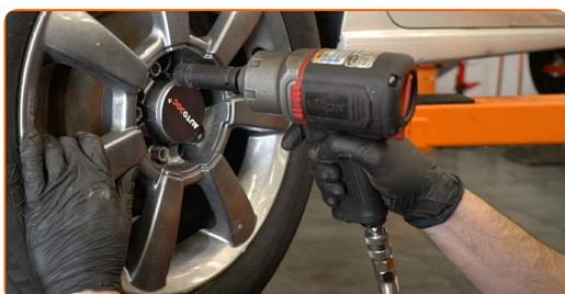
**40** Sänk bilen och arbeta i omvänd ordning, dra åt hjulbultarna. Använd hjulmutterhylsor nr. 17 Använd en momentnyckel. Dra åt den till 120 Nm vridmoment.
