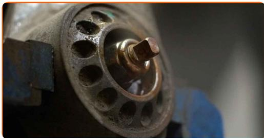
**23** Installera tillbaka skyddslocket på stötdämparfästet.
