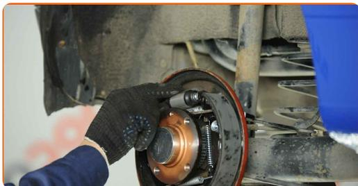
**15** Skruva fast bromscylinderns fästbultar. Använd Torx T30. Använd en momentnyckel. Dra åt den till 8 Nm vridmoment.
