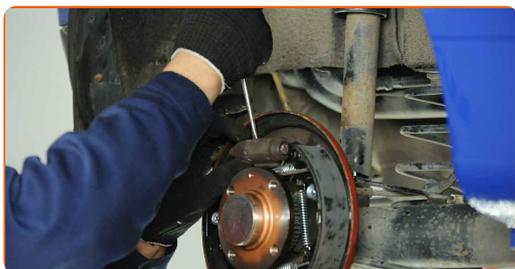
**12** Rengör bromstrumman. Använd en stålborste. Använd WD-40 aerosol.
