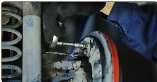
**11** Avlägsna bromscylindern från bromsskölden. Använd en plattmejsel.
