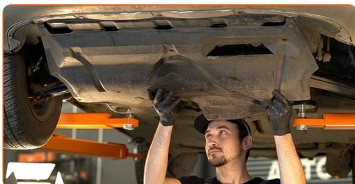
11 Skruva fast fästena för den nedre ljudisoleringen. Använd hylsnyckel Nr12. Använd en Phillips skruvmejsel.
