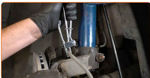
**24** Skruva loss skruven till bromsluftaren. Använd kombinyckel Nr 10.
