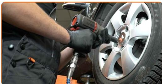
**34** Sänk bilen och arbeta i omvänd ordning, dra åt hjulbultarna. Använd hjulmutterhylsor nr. 17 Använd en momentnyckel. Dra åt den till 120 Nm vridmoment.
