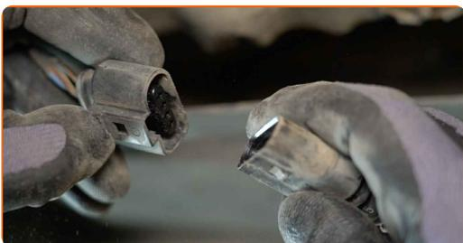
**8** Rengör lambdasondens fäste. Använd en stålborste. Använd WD-40 aerosol.
