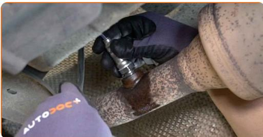
**14** Dra åt lambdasondens fäste. Använd en öppen ringnyckel #22. Använd en momentnyckel. Dra åt den till 37 Nm vridmoment.
