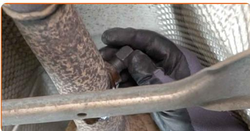
**12** Behandla lambdasonden. Använd värmebeständigt keramiskt fett.
