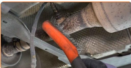
**9** Skruva loss lambdasondens fäste. Använd en öppen ringnyckel #22.
