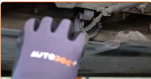
**6** Koppla bort lambdasondens ledning. Använd ett verktyg för panelclips.
