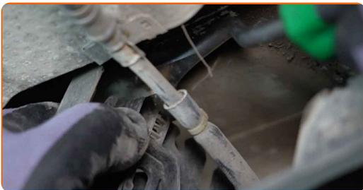
**7** Koppla loss lambdasondens kontaktdon. Använd ett verktyg för panelclips.
