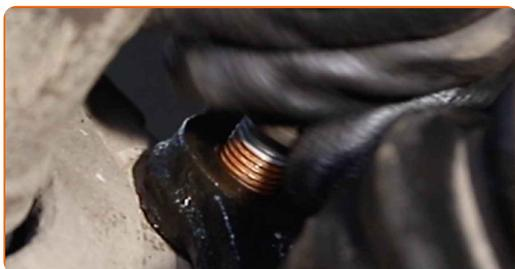
**46** Dra åt fästena till bromsokshållaren. Använd hylsnyckel Nr21. Använd en momentnyckel. Dra åt den till 190 Nm vridmoment.
