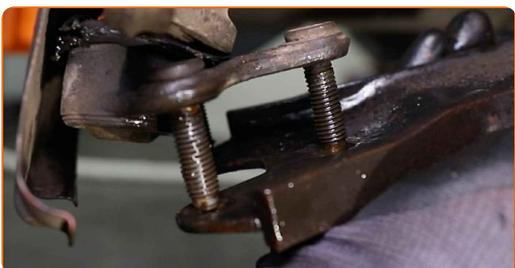
**19** Skruva loss fästelementet som förbinder drivaxeln med hjulnavet.
