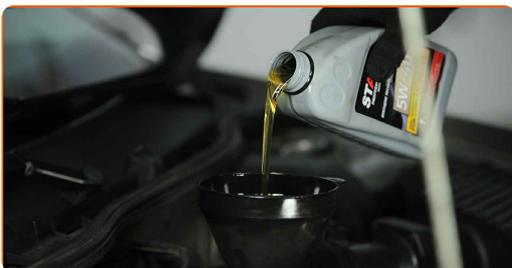
Utbyte: motorolja och filter – SKODA Octavia II Hatchback (1Z3). Tips:
