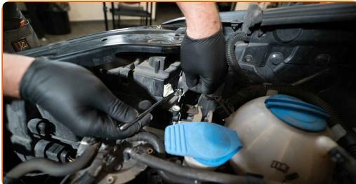
**3** Lossa glödlampssockeln genom att vrida den ca 30 grader. Avlägsna sockeln från strålkastarens monteringssäte.
