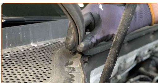
**4** Ta bort klämmorna på skyddet till torkardiket. Använd en kofot.
