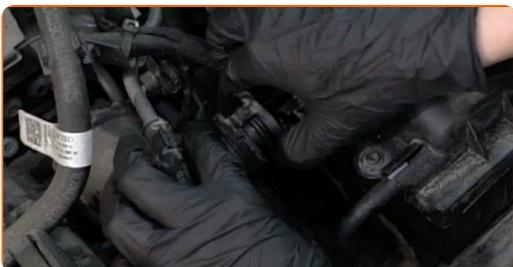
4 Koppla bort vakuumslangen från luftfilterhöljet.
