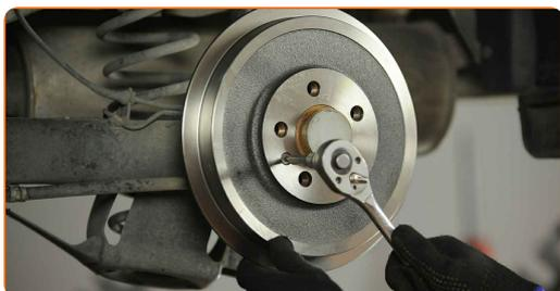
12 Behandla ytan där hjulfälgen kommer i kontakt med bromstrumman. Använd värmebeständigt keramiskt fett.
