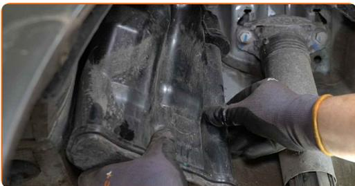
**15** Rengör fästet på stötdämparens övre delen. Använd en stålborste. Använd WD-40 aerosol.
