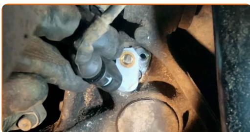
**15** Dra åt fästet som kopplar ihop ABS-sensorn med axeltappen. Använd HEX Nr. H5. Använd en momentnyckel. Dra åt den till 7 Nm vridmoment.
