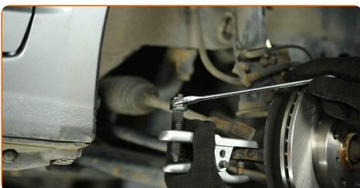
**12** Skruva loss änden från parallellstaget.
