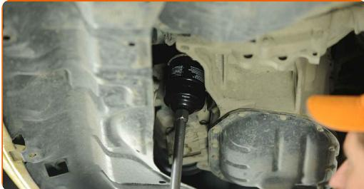
**7** Skruva loss dräneringspluggen. Använd kombinyckel Nr 14.
