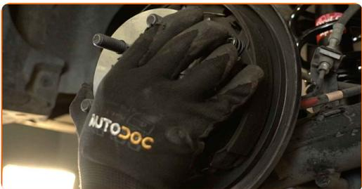
**15** Dra åt hjulnavlagrets fästbulten. Använd hylsnyckel Nr10. Använd en momentnyckel. Dra åt den till 61 Nm vridmoment.
