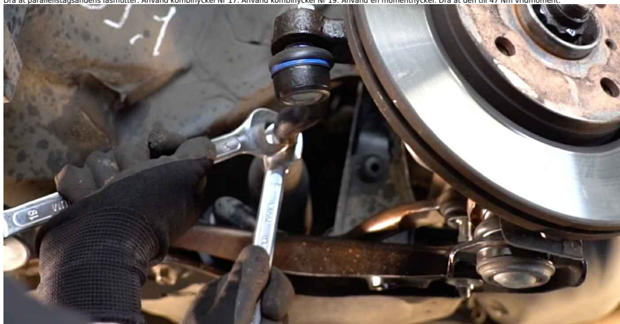
20 Installera saxsprinten som håller fast parallellstagsänden. club.autodoc.se 7-11
