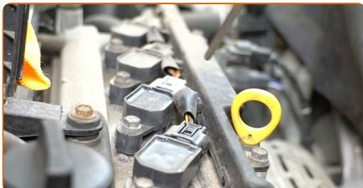
8 Skruva loss fästena på kabelknippets hållare. Använd hylsnyckel Nr10. Använd en spärrnyckel.
