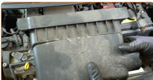
6 Täck över luftintagets slang med en mikrofiberduk för att skydda den från att smuts kommer in i systemet.
