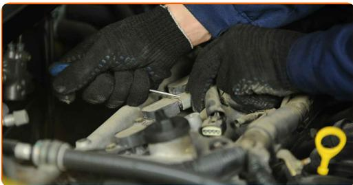
**6** Skruva loss fästelementen på tändspolarna. Använd hylsnyckel Nr10. Använd en spärrnyckel.
