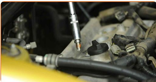
**13** Skruva fast och dra åt de nya tändstiften. Använd tändstiftsmutter nr. 16. Använd en momentnyckel. Dra åt den till 22 Nm vridmoment.
