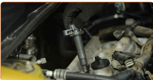
**15** Dra åt fästelementen på tändspolarna. Använd hylsnyckel Nr10. Använd en spärrnyckel.
