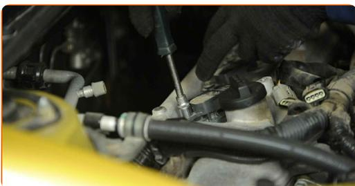
**16** Behandla tändspolekontakt med elektronikspray. Sprayen kommer att skydda emot rostning, och kommer att reducera friktionen på kontaktytorna.
