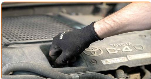
**24** Kör motorn i några minuter. Stäng av motorn när oljetrycks lampan slocknar.
