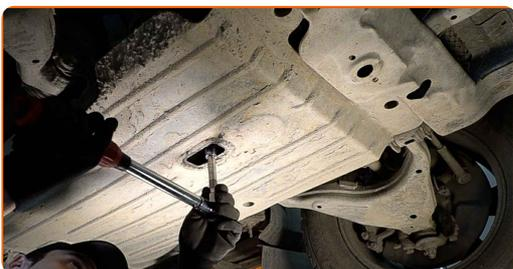
**15** Dra åt oljeavloppspluggen. Använd hylsnyckel Nr17. Använd en momentnyckel. Dra åt den till 30 Nm vridmoment.
