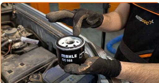
**19** Skruva fast det nya filtret på sin plats. Använd hylsnyckel 76-14F. Använd en momentnyckel. Dra åt den till 20 Nm vridmoment.
