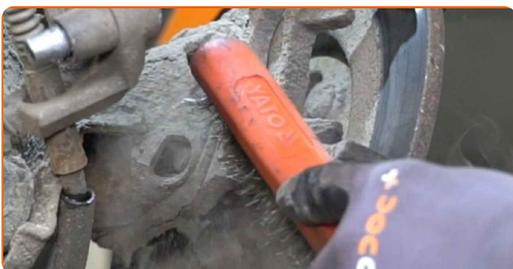
**13** Skruva loss fästena till bromsokshållaren. Använd hylsnyckel Nr14. Använd en spärrnyckel.
