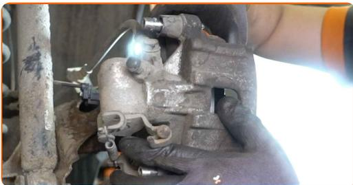
**29** Dra åt fästelementen till bromsoket. Använd HEX Nr. H7. Använd en momentnyckel. Dra åt den till 28 Nm vridmoment.
